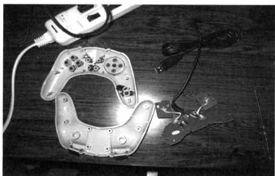
ゲームパットの改造:基盤を外します
