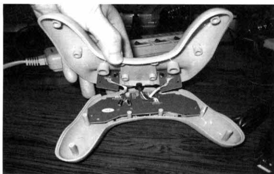
ゲームパットの改造:基盤を外します
