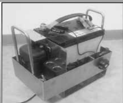
自動車用のバッテリーを利用した非常用外部バッテリー
