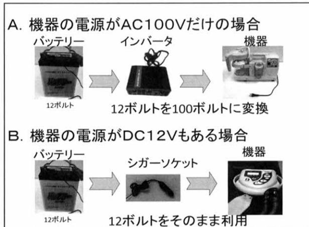
機器の電圧が100ボルトだった場合には、バッテリーはだいたい12ボルトですのでインバーターを使って100ボルトに変換します。機器が12ボルトだけのものもありますので、そのままシガーソケットで使えるケースもあります。
